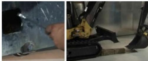
1. Dévissez et retirez le capuchon du vérin à graisse, puis reculer la poulie de tension au maximum à l'aide d'un bloc de bois.
