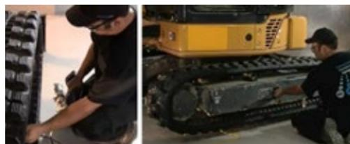
4. Revisser le capuchon du vérin à graisse, puis utiliser la pompe à graisse afin de le remplir jusqu'à ce que la tension de la chenille soit correcte.
